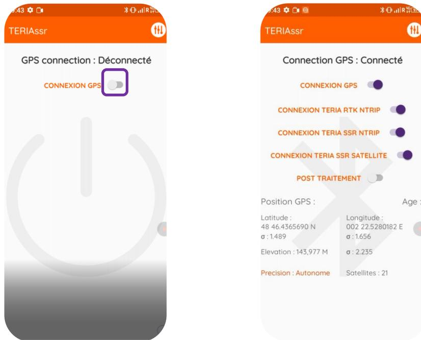
5. Activez l'acquisition pour effectuer un post-traitement (enregistrement d'un fichier **SBF** sur la puce GNSS). Si la diode satellite du PYX (2<sup>nd</sup>e en partant du bas) clignote, l'enregistrement est effectif.
